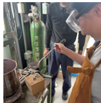
酒器づくりのワークショップ、溶かしたスズを型に流し込む
