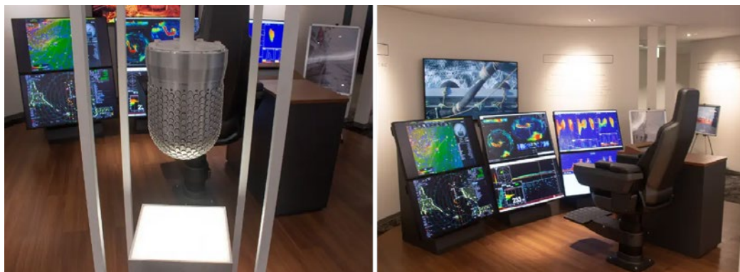
本社1階にある体験型ショールームの一部。ソナー（写真左）は、超音波を出し、その反射波を捉えて水中の物体を探知する技術。同右は、最先端の漁業システムの疑似体験ができるブース
