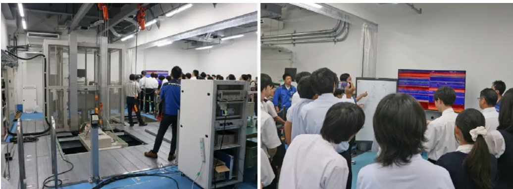
西宮本社の開発棟に設置された水深5mの実験用大型水槽(写真左)。水中のごみを魚群探知機がどう捉えるかをモ
